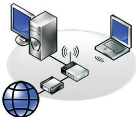
I dispositivi vengono collegati tramite wireless e coprono un'area relativamente ridotta, generalmente all'interno di un'abitazione o un edificio. La connessione wireless usata per impostare la WLAN è generalmente la Wi-Fi (802.11x).
